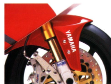
Komplett einstellbare Feder-/Dämpfungselemente von Ohlins
