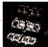
Nach vorn geneigter Vierzylinder-Viertakt-Motor
