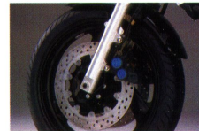
Einteilig gegossene Vierkolbenbremszangen wie an der YZF-R1
