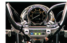
Dieses Cockpit liefert auf einen Blick alle wichtigen Informationen: Geschwindigkeit, Blinker, Kraftstoff und Licht
