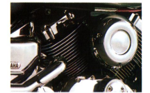
V2 mit klassischem Outfit und Fahrtwindkühlung
