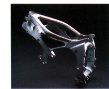
Deltabox II-Aluminium-Rahmen mit kurzem Radstand
